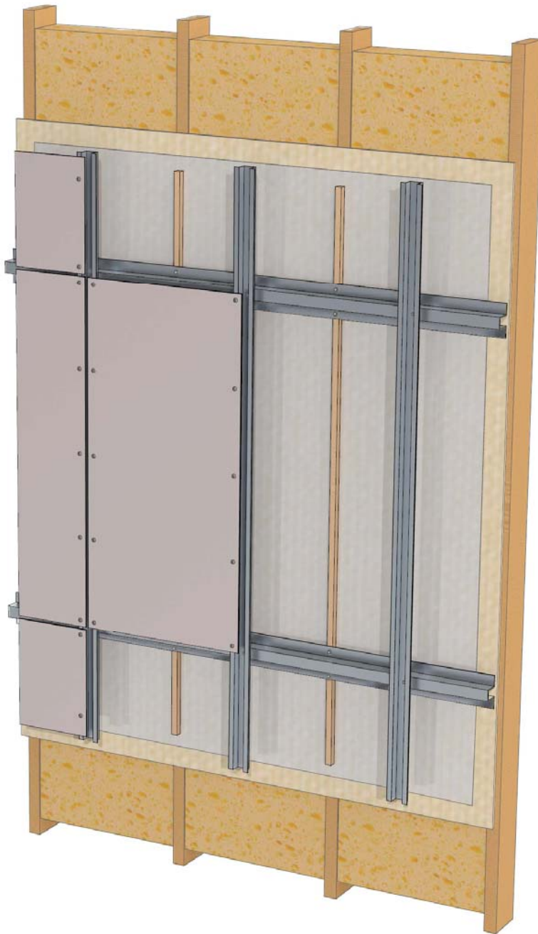
Figure 19 – principe de mise en œuvre du système LARSON riveté/vissé sur COB
