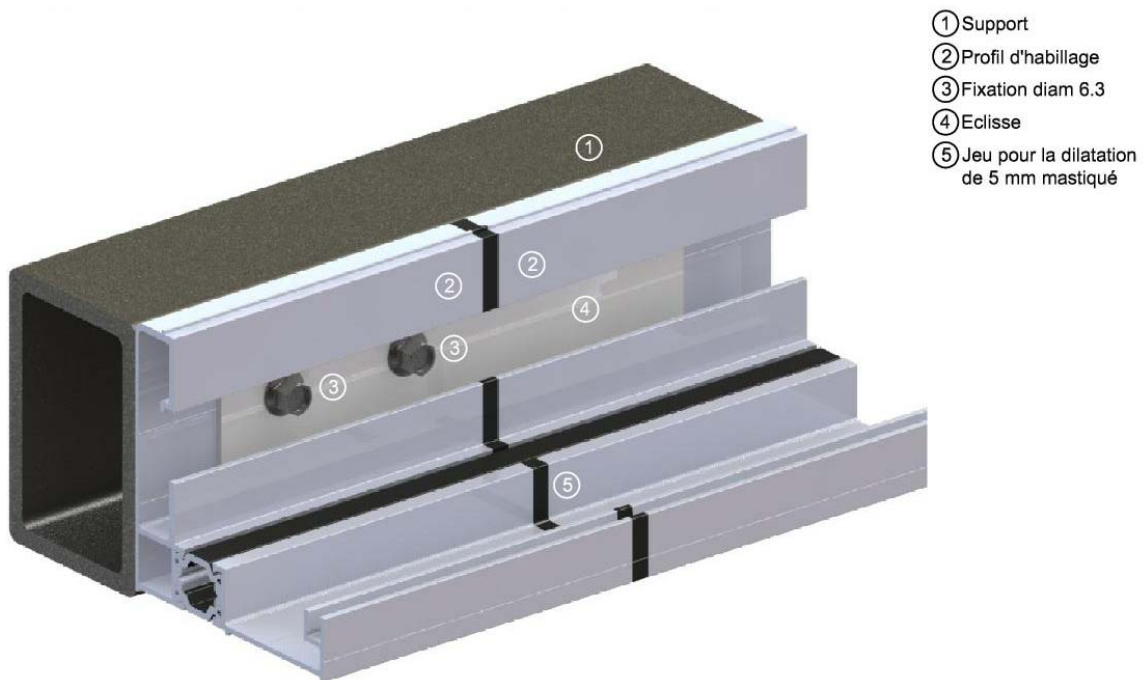
Principe d'aboutage des profils d'habillage
