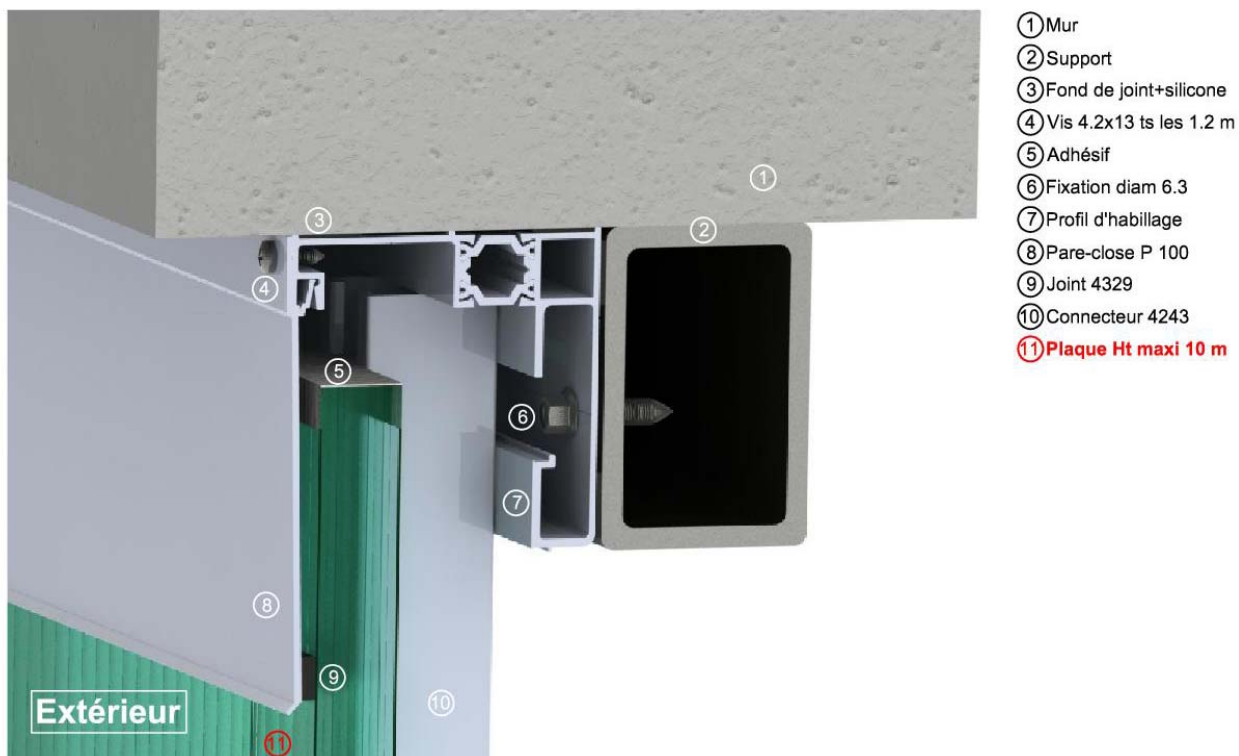
Figure 10 - Pose normale - Principe de pose en tête de façade pour des hauteurs comprises entre 0 et 10 mètres
