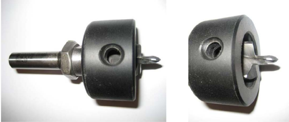
Figure 3 – Perceuse – Fraiseuse pour fixations sur EQUITONE [LINÉA]
