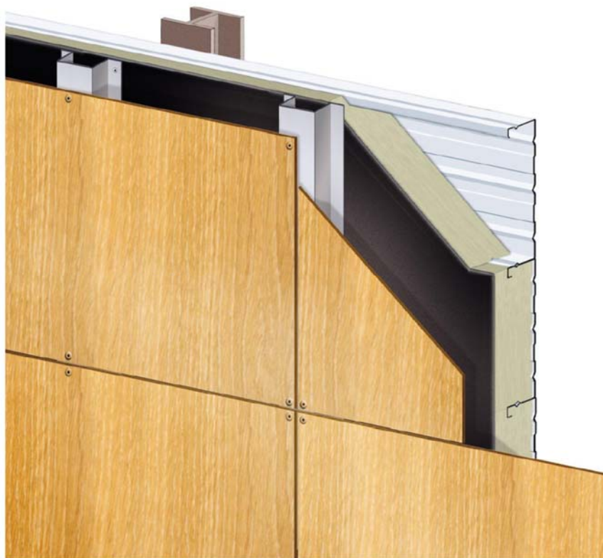
Figure 2 – Schéma de principe panneaux avec pare-pluie synthétique
